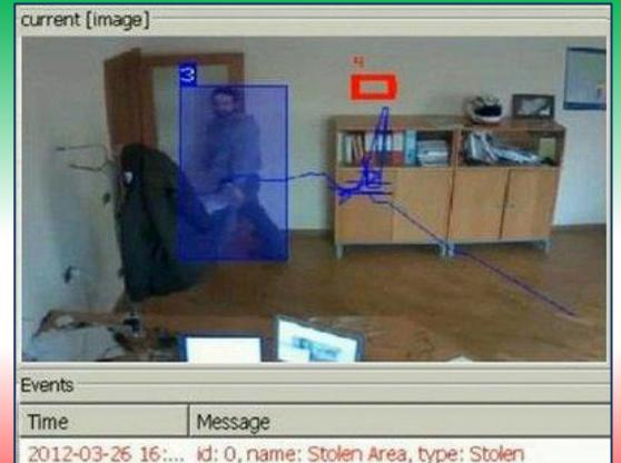
Detecção automática de roubo baseada em itens faltante.
