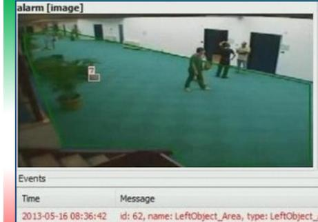
Detecção automática de itens deixados inatendido
