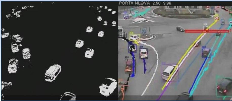
Ведение подсчёта транспортных средств на дороге, автоматическое проведение мониторинга пробок.
